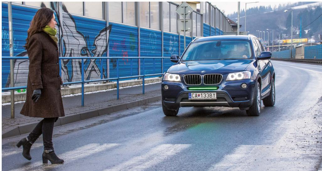
Die Vordere Bremsleuchte (VBL) ist eine vielversprechende Maßnahme zur Verbesserung der Verkehrssicherheit. Sie kann mit einem kostengünstigen Nachrüst-Kit an der Front aktueller Fahrzeuge angebracht werden und leuchtet zeitgleich mit den etablierten hinteren Bremsleuchten – mit dem entscheidenden Unterschied, dass die Brems-Information nun auch Verkehrsteilnehmenden zur
