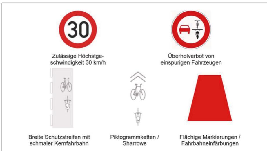
Bild 2: Lösungsvorschläge für Radverkehr bei beengten Verhältnissen
