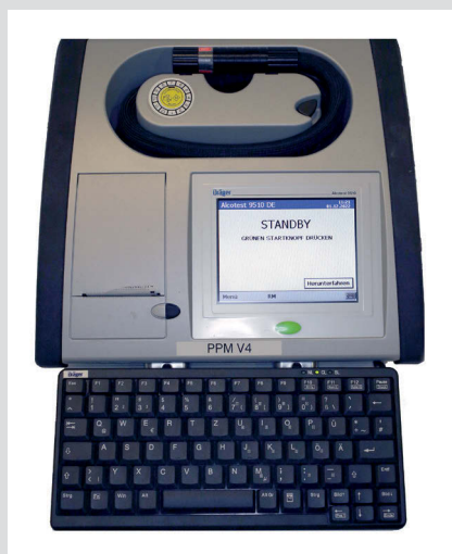
Bild 1: Atemalkoholanalysegerät Dräger Alcotest 9510 DE
