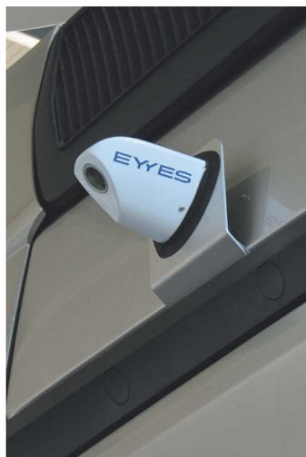
Der Kamera-Wing des neuen KI-Fahrzeugsicherheitssystems CarEYE SAFETY ANGLE im montierten Zustand an einem Lkw
