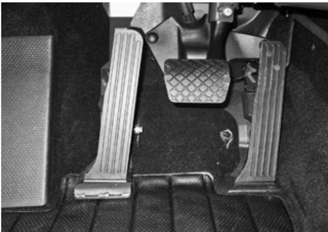
**Bild 2.** Elektronisches Linksgas wahlweise als Rechts- oder Linksgas nutzbar
