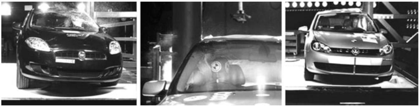
**Bild 8.** Crashtests mit Anprall gegen einen Pfahl bei 29 km/h Geschwindigkeit
