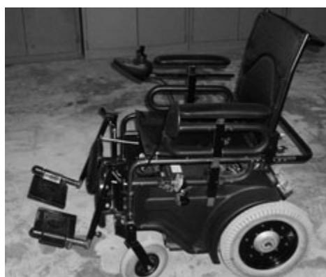
Bild 2. Elektrischer Rollstuhl „Standard“
