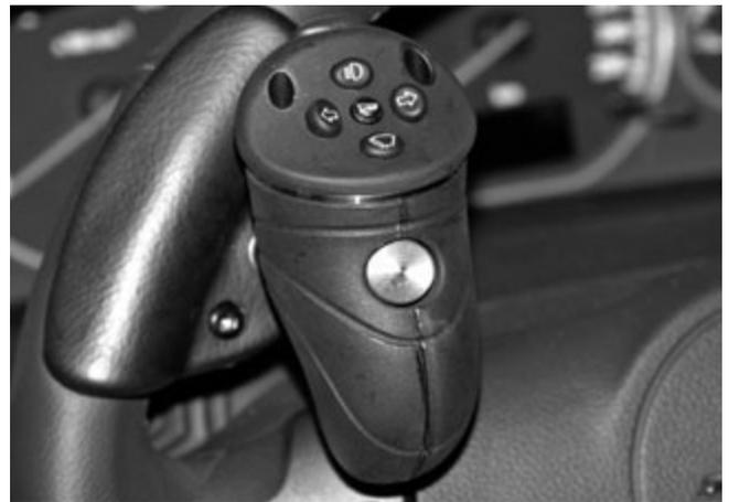
**Bild 3.** Multifunktionsdrehknopf – Einarmbedienung mit integrierten Funktionstasten für die Sekundärfunktionen
