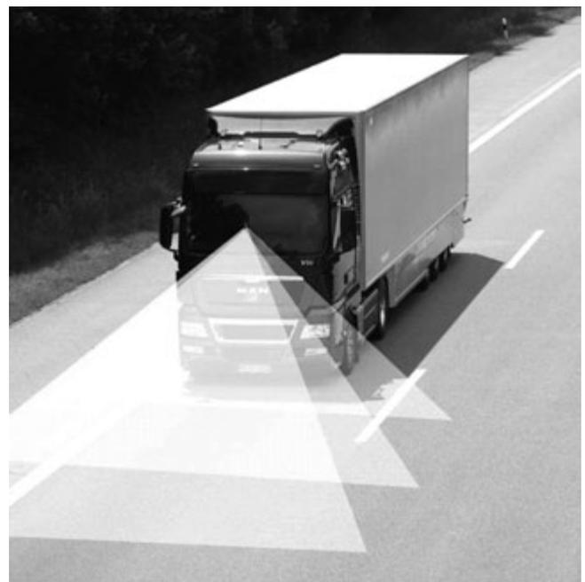
**Bild 6. Wirkungweise des Spurassistenten** (Bild: MAN)
