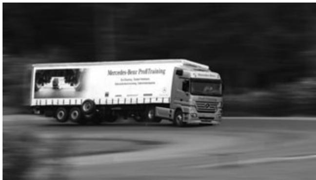
**Bild 8. Schleuderndes Fahrzeug wird durch ESP wieder „auf Kurs“ gebracht** (Foto: Daimler)
