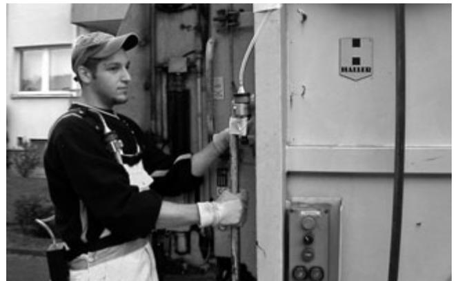
Bild 3. Probenträger am Trittbrett-Arbeitsplatz (Handgriff) und am Lader (Schulter)
