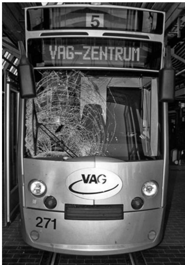
Bild 1. Beschädigungen am Kopfmodul des Straßenbahnzugs
