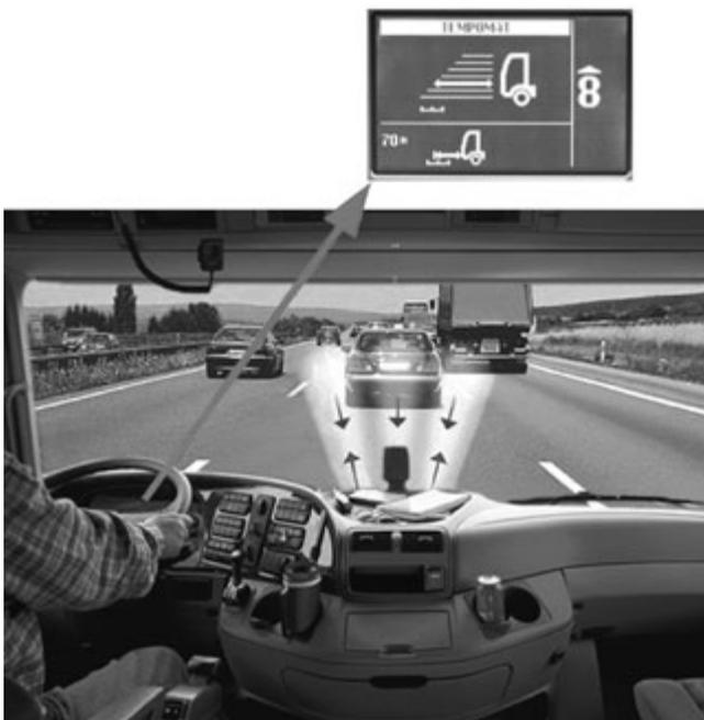
**Bild 4. Wirkungweise und Anzeigeeinheit des Abstandsregeltempomaten** (Bild: Daimler)
