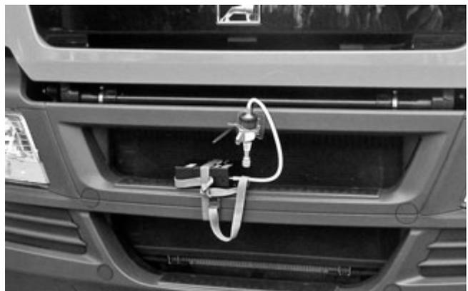
Bild 1. Referenzmessung an der Fahrzeugfront
