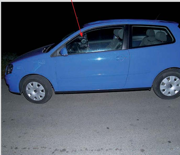
Bild 7: Vergleichsfahrzeug mit positionierter Messkamera
