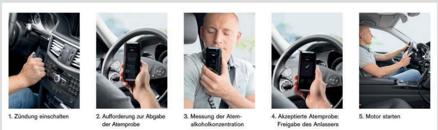
Bild 1: Funktionsweise Interlock 7000
