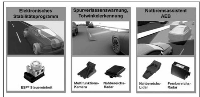
Abb. 4: Fortschrittliche Fahrerassistenz – Schlüsseltechnologien
